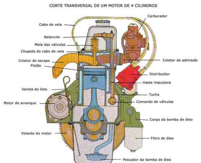
A energia inicial necessária para por o motor em movimento é fornecida pelo motor de arranque. Este engrena numa cremalheira que envolve o volante do motor, constituído por um disco pesado, fixado à extremidade do virabrequim ou árvore de manivelas. O volante do motor amortece os impulsos bruscos dos pistões e origina uma rotação relativamente suave ao virabrequim.
