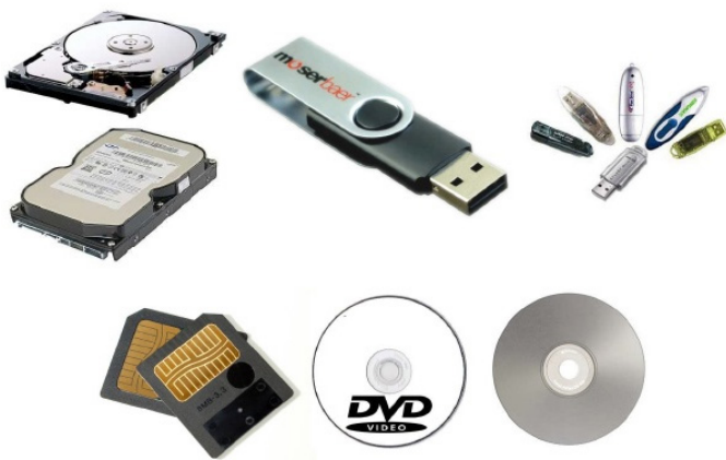
Periféricos de armazenamento. 11
