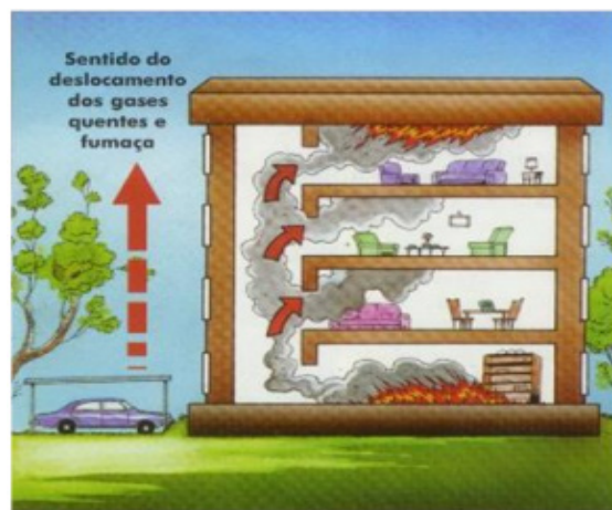
Figura 4 - Transferência de calor por convecção
