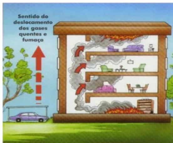
Figura 4 - Transferência de calor por convecção
