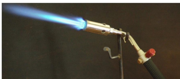
Figura 8 – Chama pré-misturada derivada de maçarico Fonte: http://www.prevencaonline.net/2010/03/operacao-com-macarico.html
