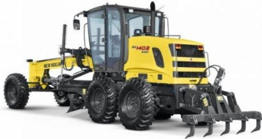
Quando se fala em máquinas para terraplanagem não é nem possível imaginar uma operação sem a motoniveladora. Essa máquina é a responsável por espalhar a terra nivelando todo o terreno a partir de sua lâmina central. Além disso, a motoniveladora tem capacidade para atuar também em terrenos acidentados, criando superfícies inclinadas ou transversais.
