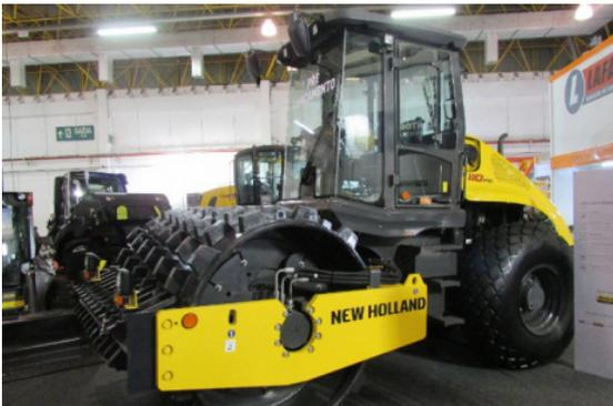
Depois que a motoniveladora deixa o terreno devidamente nivelado, o rolo compactador entra em ação para comprimir o solo com seu peso e vibração, tornando-o firme e resistente.
