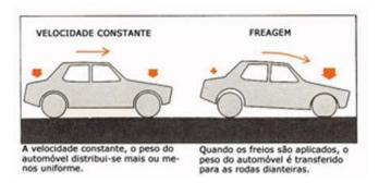
A eficiência dos freios devidamente regulados e em boas condições deverá ser, pelo menos, de 80%; contudo, para obter as distâncias de frenagem indicadas, os pneus devem aderir devidamente à estrada. Normalmente é difícil avaliar a possibilidade de aderência ao pavimento apenas pelo aspecto deste e, por isso, é sempre aconselhável utilizar cuidadosamente os freios em condições de chuva ou gelo.
