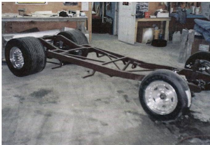
**Alinhamento do chassi:** o desalinhamento do chassi pode afetar o alinhamento das rodas dianteiras, ocasionando um desgaste mais intenso de vários componentes.
