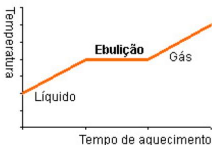
O **ponto de ebulição** de uma substância é a temperatura a que essa substância passa do estado líquido para o estado gasoso.
