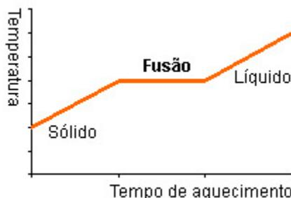
O ponto de fusão de uma substância é a temperatura a que essa substância passa do estado sólido para o estado líquido.
