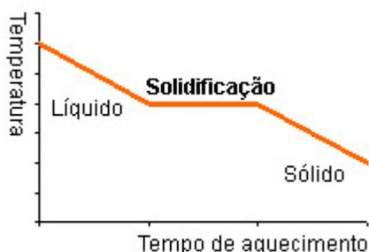
No caso da água o ponto de solidificação é de  $0^{\circ}\text{C}$ . Assim, a água permanecerá a  $0^{\circ}\text{C}$  até que toda ela congele para só depois sua temperatura começar a diminuir para  $-1^{\circ}\text{C}$ ,  $-2^{\circ}\text{C}$  etc.
